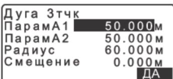
8. Нажмите [ДА] в экране на шаге 7, чтобы вычислить координаты и расстояние до точек KA1, KE1, KE2, KA2. Результаты вычислений отображаются на экране. Для переключения экранов <Дуга Зтчк/KA1>/<Дуга Зтчк/KE1>/<Дуга Зтчк/KE2>/<Дуга Зтчк/KA2> нажмите {▶}/{◀}.
