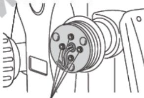
☞ Вставьте шестигранный ключ, входящий в набор инструментов для юстировки, в головки верхнего и нижнего юстировочных винтов.
