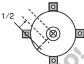
Крышка сетки нитей оптического отвеса
