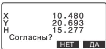
7. Введите расстояние от 2-го отражателя до измеряемой точки и нажмите клавишу **{ENT}**. На экране отображаются координаты измеряемой точки.
