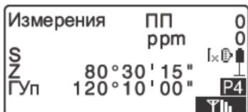
Значок Bluetooth указывает на состояние соединения.
