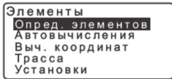
4. В экране <Опред. элементов> выберите "Ввод ВУ", чтобы ввести вершину угла.
