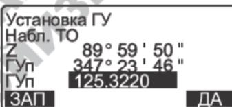
Наведитесь на вторую визирную цель. Выводится отсчет по горизонтальному кругу на вторую визирную цель с учетом установленного отсчета по горизонтальному кругу на первую точку.
