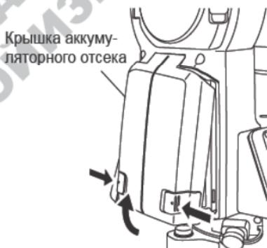
2. Вставьте аккумулятор в направлении стрелки, изображенной на корпусе аккумулятора.
