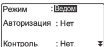
5. Установите "Соед" (Соединение). С помощью клавиш **{◀/▶}** выберите соответствующее оборудование из списка *Bluetooth* устройств, зарегистрированных тахеометром.
