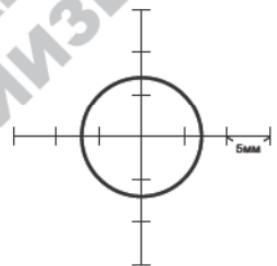
● Марка для юстировки лазерного отвеса
