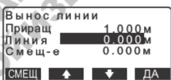
3. Нажмите клавишу **[ДА]** в экране на шаге 2. Координаты измеряемой точки вычисляются и выводятся на экран.
