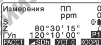
В момент измерений параметры дальномера (режим измерений, значения постоянной призмы и атмосферной поправки) мигают на экране.
