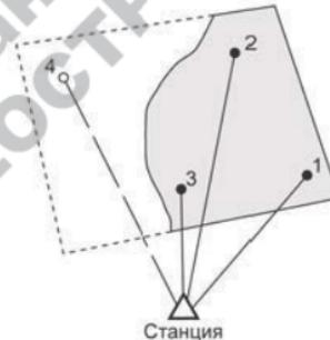
После этого вы можете навести прибор в сторону плоскости; прибор вычислит координаты точки №4, принадлежащей заданной плоскости, в сторону которой направлен прибор. При этом на дисплее тахеометра вы увидите значения вычисленных координат и сообщение "4-е измерение. ОК?". Вычисленную точку можно записать в память тахеометра в виде координат [XYH] или в виде измерений [ГВР].
