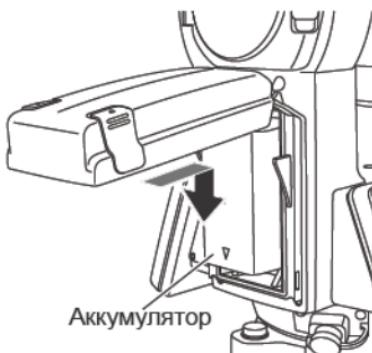
3. Закройте крышку аккумуляторного отсека. При фиксации крышки раздается характерный щелчок.
