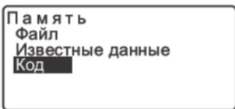
3. В экране <Код> выберите "Экспорт" и нажмите {ENT}. Начинается вывод кодов. Когда вывод кодов завершен, вновь отображается экран <Код>.
