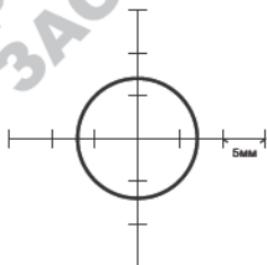
● Марка для юстировки лазерного отвеса
