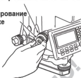
**ПРОЦЕДУРА Центрирование с помощью окуляра лазерного отвеса (⊕)**
